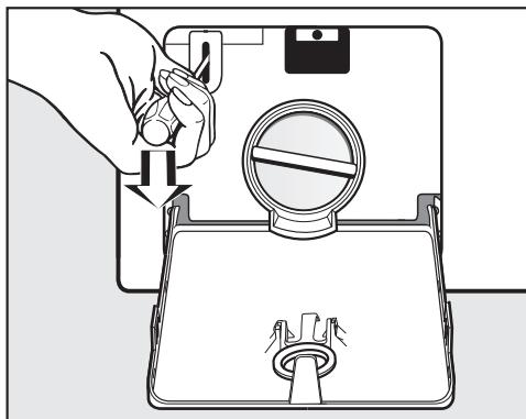
■ Разблокируйте дверцу с помощью отвёртки, потянув язычок блокировки вниз.
