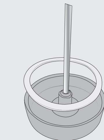
При необходимости вы можете снять соединительный элемент и уплотнительное кольцо с крышки ёмкости для молока. Если вы хотите снять трубку из нержавеющей стали, то слегка выдавите соединительный элемент из внутренней части крышки. Вымойте отдельные детали в посудомоечной машине.
