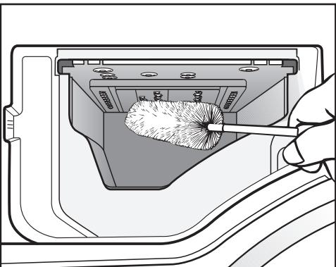
■ С помощью ёршика для мытья бутылок регулярно удаляйте остатки моющих средств и отложения известняка с форсунок подачи воды в отсеке.
