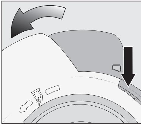
■ Поверните крышку контейнера для сбора пыли в направлении стрелки до первого упора. Для этого используйте серую плоскость для захвата.
