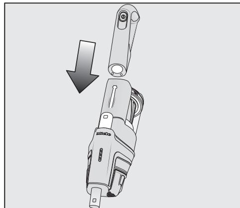
Для быстрого и целенаправленного удаления крошек и ворсинок лучше всего использовать блок PowerUnit без всасывающей трубы и электрощётки.
