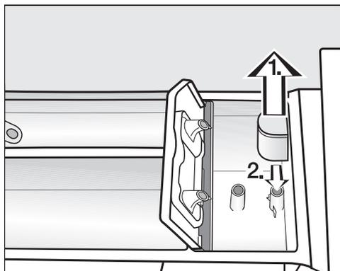
1. Вытяните сифон из ячейки
