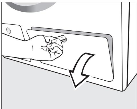
■ Для открывания потяните крышку отсека системы TwinDos.
