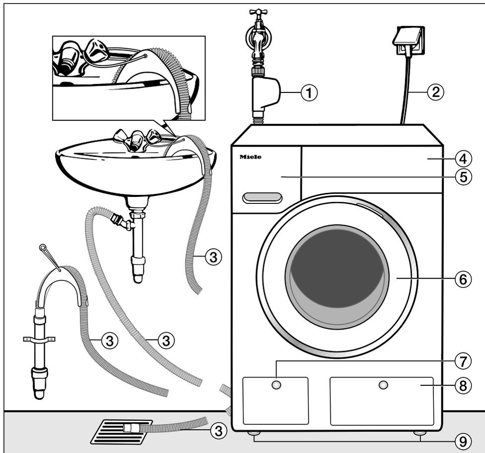
① Заливной шланг с системой защиты от протечек Waterproof
