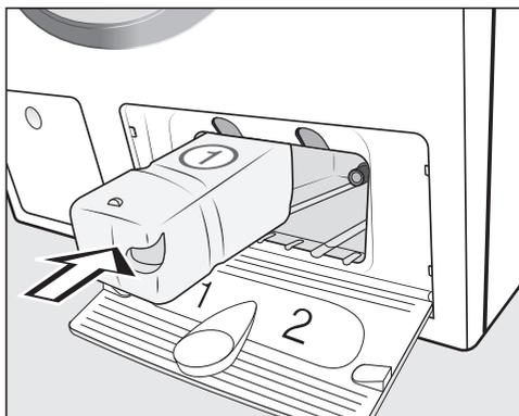
■ Задвиньте картриджи с моющим средством для **UltraPhase 1** в **отсек 1** до защёлкивания фиксатора.
