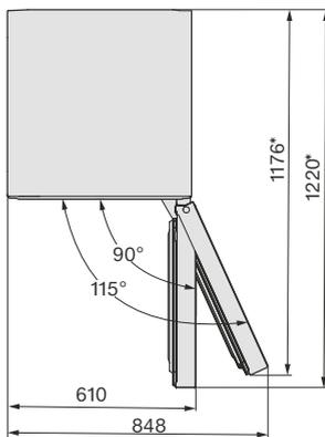
\* Размер без смонтированных проставок для соблюдения расстояния от стены. При использовании прилагаемых проставок глубина прибора увеличивается на 15 мм.
