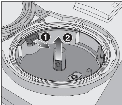
■ Разблокируйте держатель, потянув за жёлтый язычок в направлении стрелки ① и одновременно потяните вверх держатель картриджа PowerDisk за области жёлтого цвета ②.
