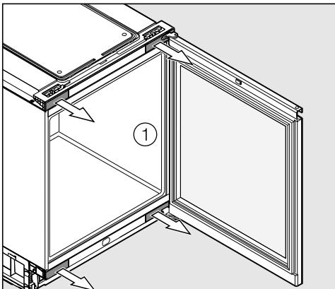
■ Снимите детали облицовки ① с помощью отвёртки.
