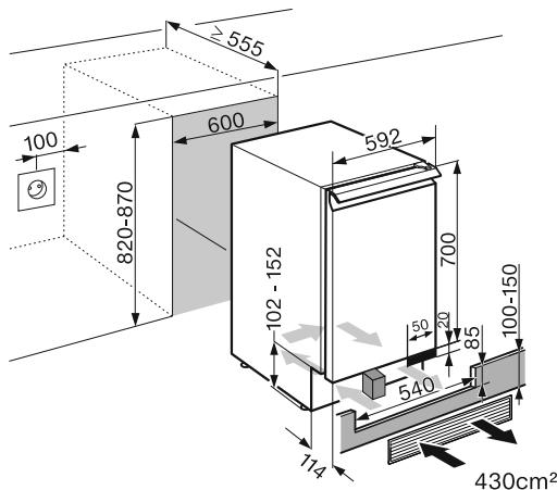
Перед встраиванием обратите внимание на то, чтобы шкаф для встраивания точно соответствовал заданным размерам для встраивания. Обязательно должны соблюдаться размеры вентиляционных отверстий. Вырез в цокольной панели для прилагаемой вентиляционной решётки должен быть отцентрирован с винным холодильником, чтобы была гарантирована правильная работа прибора.
