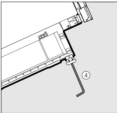
■ Вы можете выворачивать ножки прилагаемым гаечным ключом ③ или с помощью торцового шестигранного ключа ④.
