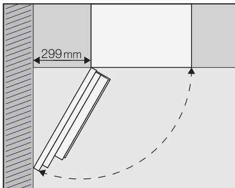
Проверьте, имеется ли между стеной или т.п. слева от кофемашины расстояние минимум 299 мм, чтобы вы могли достаточно широко открывать дверцу и вынимать левый контейнер для кофейных зёрен (угол открывания дверцы минимум 120°).
