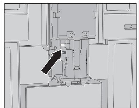
Соединительный элемент трубки подачи молока вынимать не нужно. При необходимости очистите соединительный элемент щёткой для чистки.
