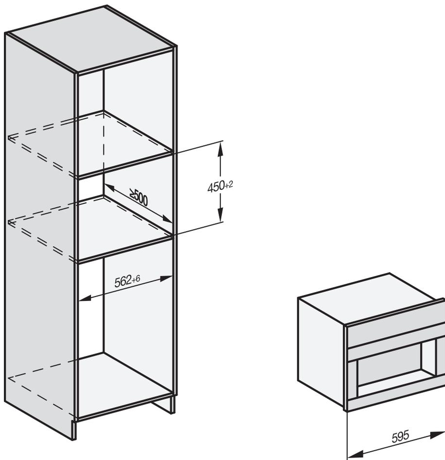
Комбинация с другими встраиваемыми приборами Miele возможна. При этом кофемашина должна быть отделена снизу цельной промежуточной полкой. При комбинации со встраиваемым подогревателем посуды/пищи промежуточная полка не требуется.
